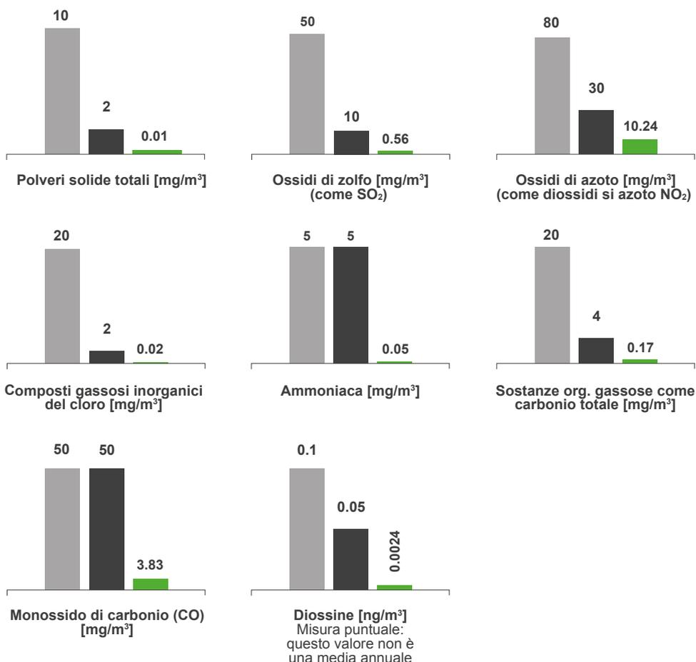
Durante il mese di giugno 2024 un laboratorio esterno ha effettuato una misura delle concentrazioni nei fumi di tutti gli inquinanti ai sensi dell'OIAt e della licenza edilizia. Le analisi hanno dimostrato che sia le concentrazioni degli inquinanti monitorati in continuo dalla stazione di misura dell'impianto che le concentrazioni degli altri inquinanti (metalli, composti del fluoro e diossine) rispettano i limiti.
